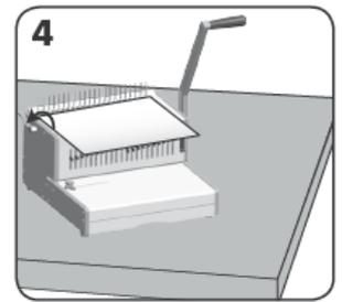
4 Когда все пробитые листы будут надеты на пружину, потяните рычаг фиксации пружины назад, чтобы закрыть пружину и извлечь сброшюрованный документ
